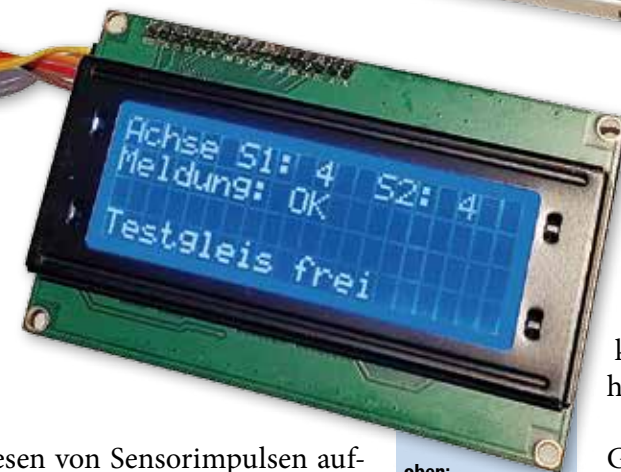
oben: Unsere Testumgebung verfügt über drei Sensoren, wobei zwischen S1 und S2 ein Vergleich stattfindet und der dritte nur den Zustand des Testgleises auf dem Display und per LED anzeigt.
