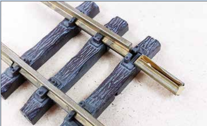
Aus dem freigebohrten Verbindner lässt sich nun mit leichtem Druck die Schiene herausziehen.
