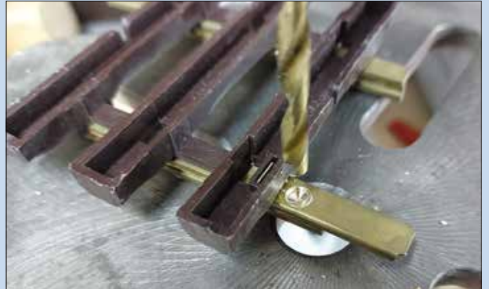
Um bei der Schienendmontage den Verbindner nicht zu zerstören, wurde er von unten in der Pressstelle mit einem Vier-Millimeter-Bohrer leicht angebohrt.
