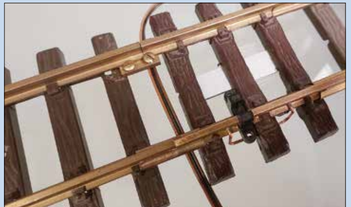
Das Sensorgleis im Gleisverbund. Die Brücke kann auch weggelassen werden, um das Gleis in Abhängigkeit zum Programm schaltbar zu machen.
