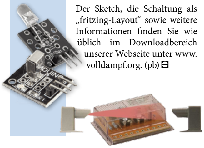
unten: Weitere einzelne Sender und Empfänger für eine Lichtschranke bieten sich für den „wasserdichten“ Aufbau an.
