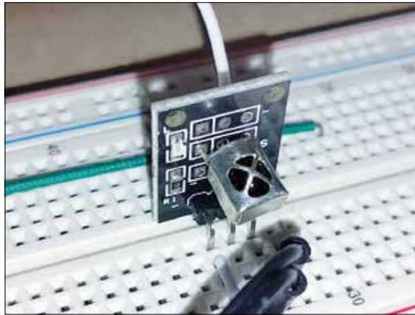
oben: Der Hall-Sensor reagiert auf den Neodym-Magneten. Mitte: Der IR-Sensor. unten: Der Relais-Baustein wird für eine eventuelle Umpolung benötigt.
